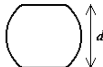
9. ábra: A keverőfej keresztmetszete és a d magasság definíciója
